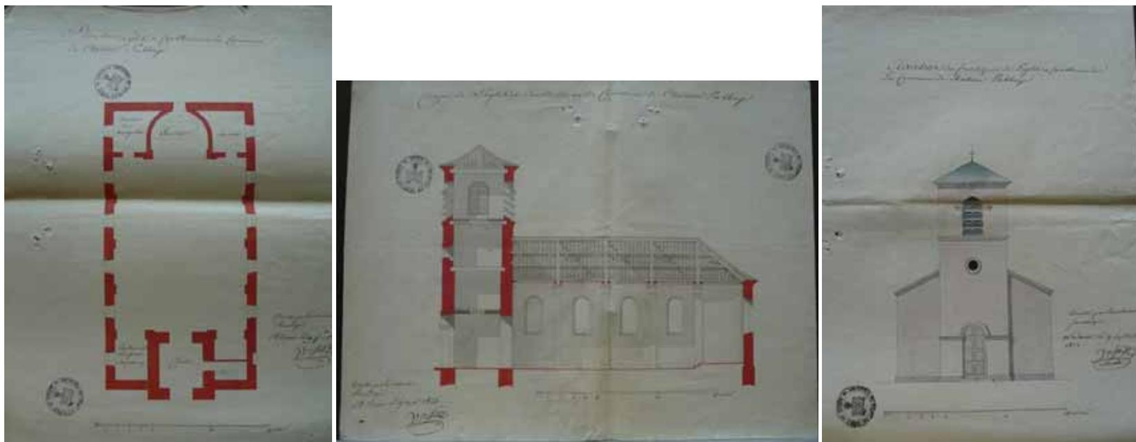
Extraits des dessins de l'architecte Voisin, datés de 1822. De gauche à droite : plan, coupe transversale sur le clocher et la nef, élévation de la façade principale (source : ADN, 20142/44).
